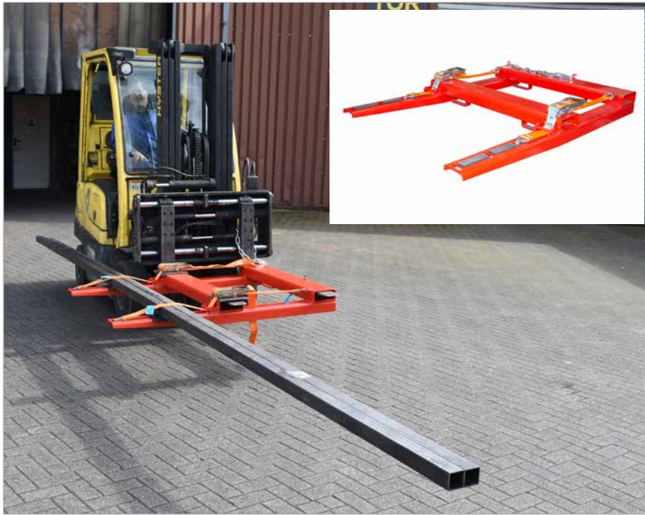
Position de préhension pour passer par ex. une porte
