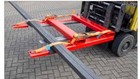
Position de préhension pour charger ou décharger
