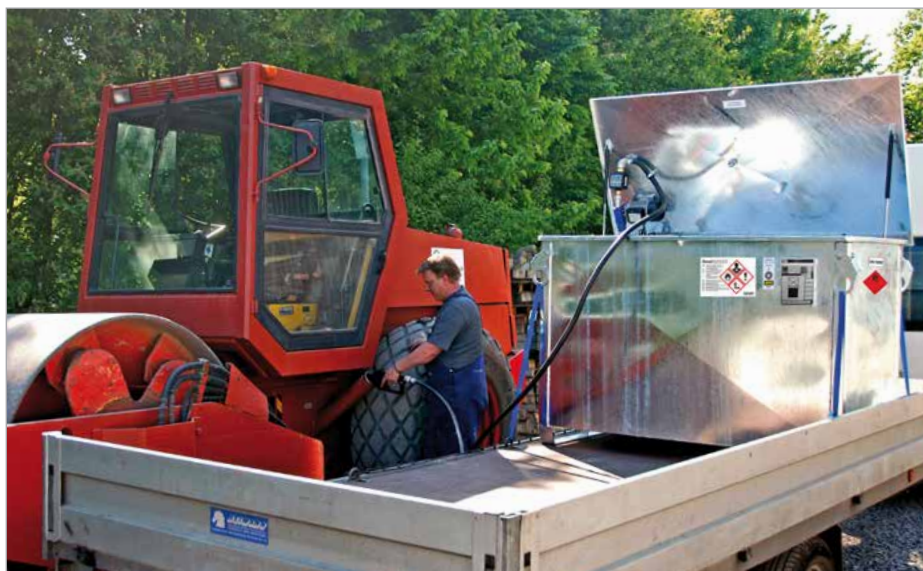
MT 1000 équipé d'une pompe électrique
