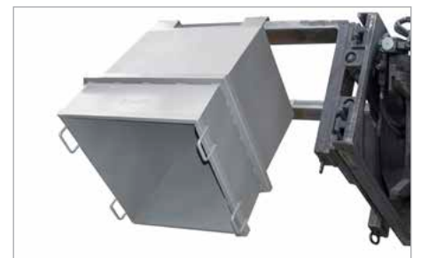
UC-Entleerung mit Stapler-Drehgerät
