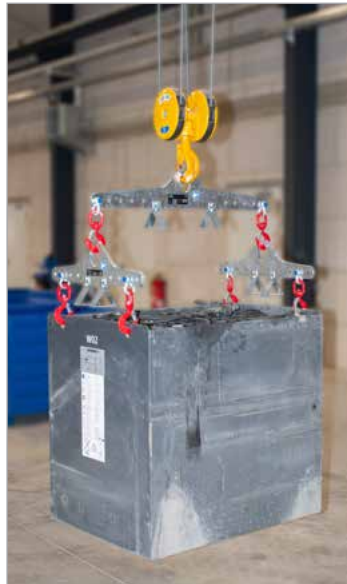
Kombination aus mehreren Traversen zur H-Traverse
