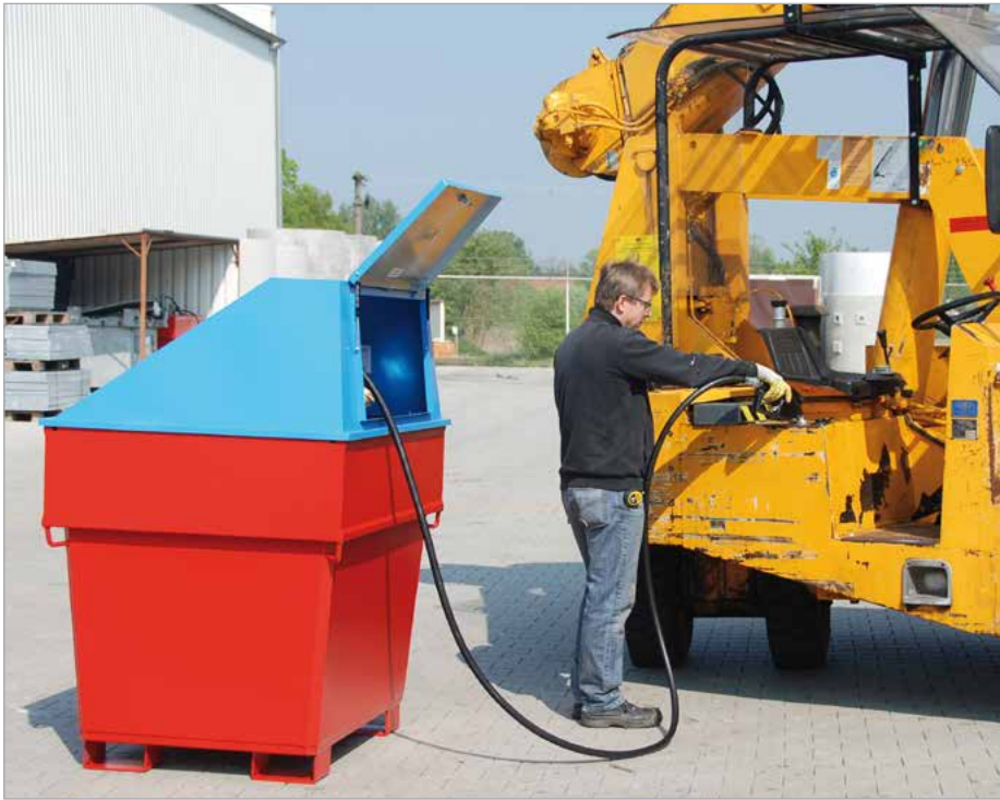
MD 800 mit Elektropumpe
