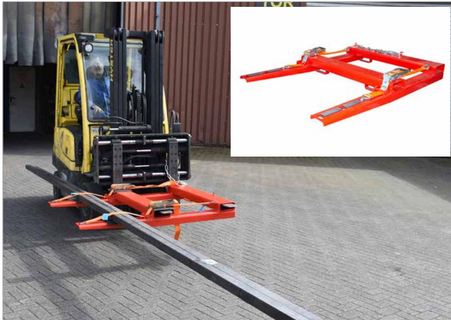
Aufnahmeposition zum Transport z.B. durch Tore oder Gänge
