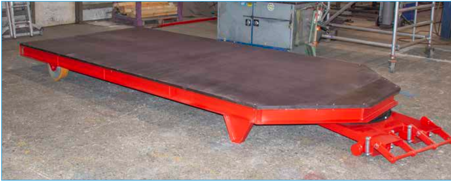
STS mit rutschhemmenden Betosiebplatten
