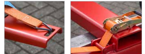
Sicherung... ..durch Spanngurte
