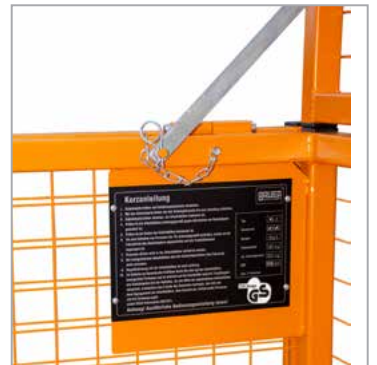
Sicherung der abklappbaren Schutzgitter Kurzanleitung
