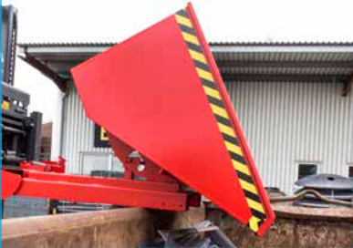
Abrollmechanismus mit automatischer Entriegelung
