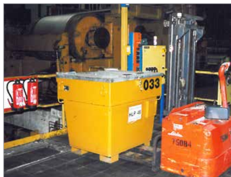
Mobile Öl-Versorgung von Maschinen
