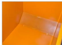
Tôle perforée pour bac à copeaux de type (CS)
