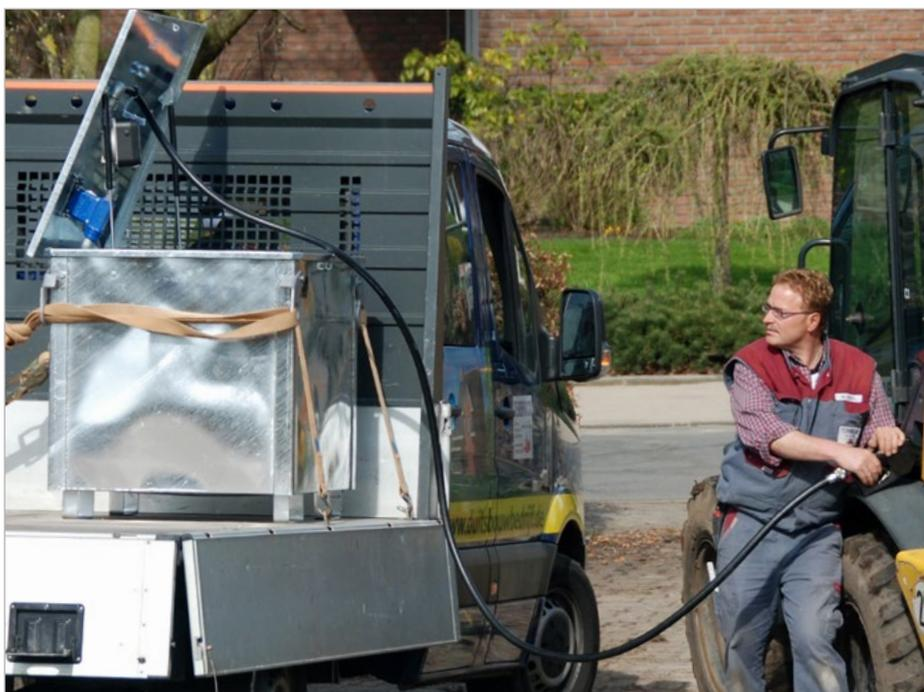
**Cuve mobile simple parois pour l'alimentation de machines de construction et de travail. Autorisé pour le transport de carburant pour la consommation immédiate selon «ADR 1.1.3.1 c»**
