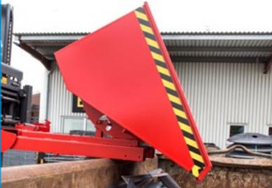
Ces bennes possèdent non seulement un système de basculement dérouleur mais également un déverrouillage automatique. En posant ou en prenant appui sur le bord de votre benne de collecte, vous déclenchez le basculement de la benne. Un déclenchement du basculement par câble n'est plus nécessaire.
